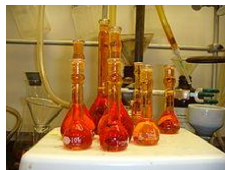
Freshly prepared aqua regia to remove metal salt deposits
